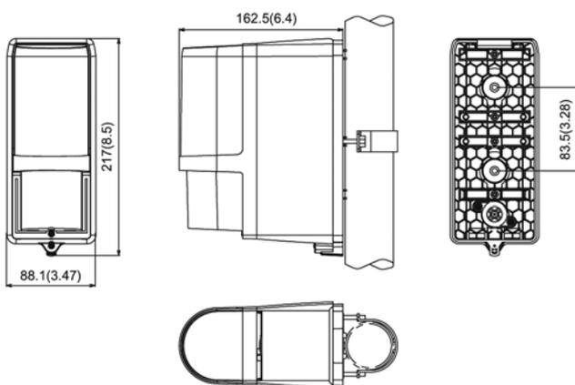
Les dimensions du poteau doivent être comprises entre 43 et 48 mm.
