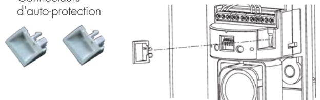
Sans les connecteurs d'auto-protection, les LEDs restent allumées, ce qui consomme l'énergie des batteries.
